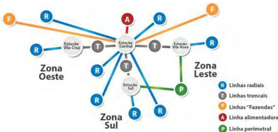
Figura 25 – Esquemática do Sistema de Transporte Coletivo de Poços de Caldas MG
